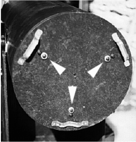
systèmes de vis pousantes-tirantes à l'arrière d'un télescope
